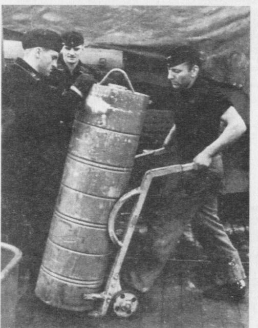
**Вверху:** подача картузов из зарядного погреба (слева) и их погрузка на лоток 28-см орудия в башне «Гнейзенау» (справа).
